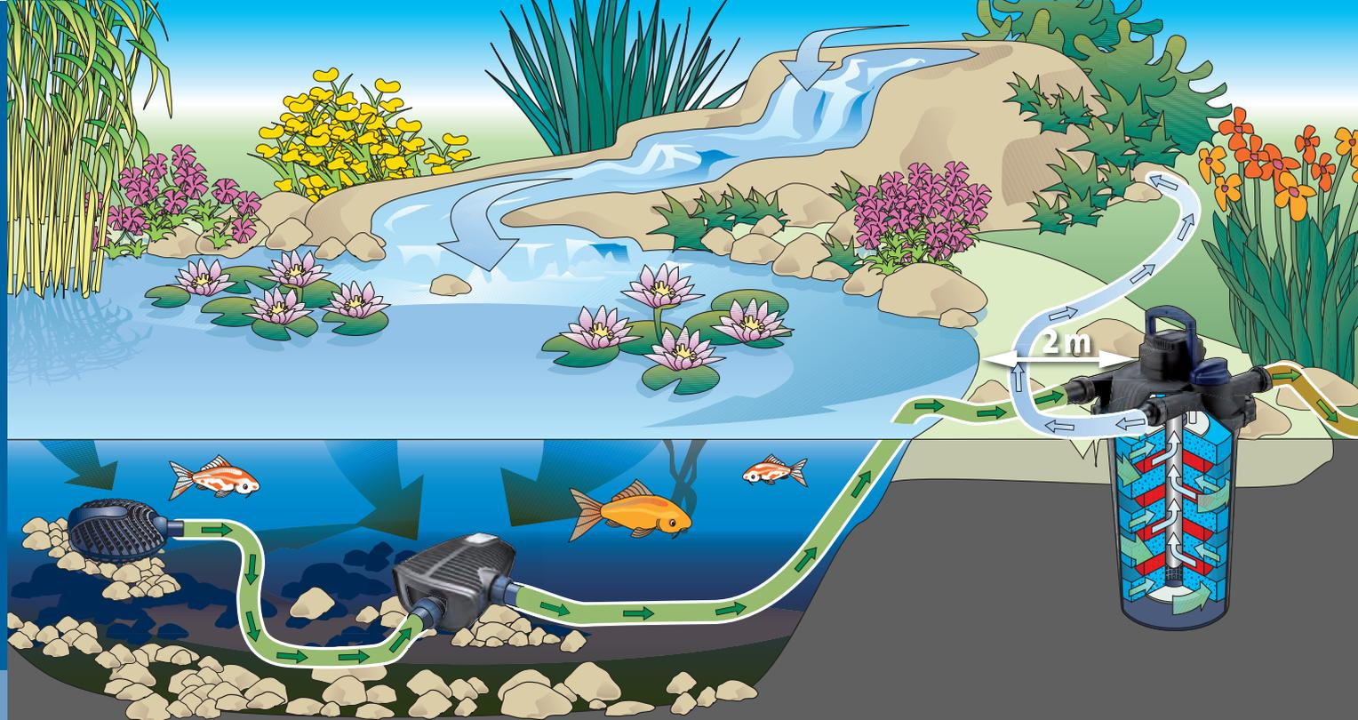
Rappresentazione schematica: filtro a pressione FiltroClear in combinazione con pompa per filtri e ruscelli
