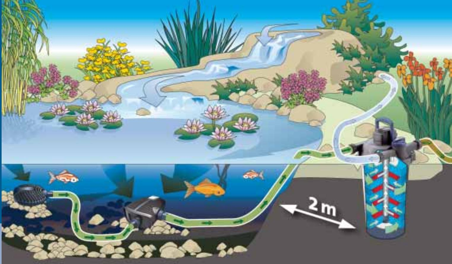
Rappresentazione schematica: Pompa per filtri e ruscelli AquaMax Eco Premium (PRO) utilizzata in combinazione con un filtro a pressione OASE FiltoClear (PRO)
