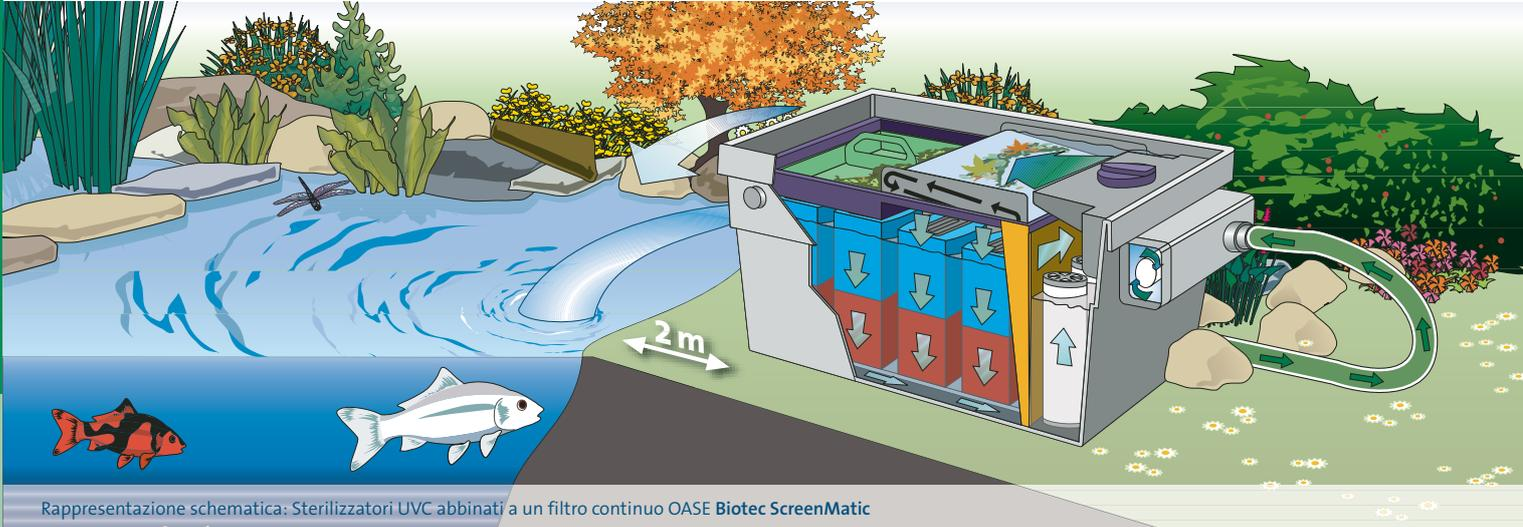
Rappresentazione schematica: Sterilizzatori UVC abbinati a un filtro continuo OASE Biotec ScreenMatic
