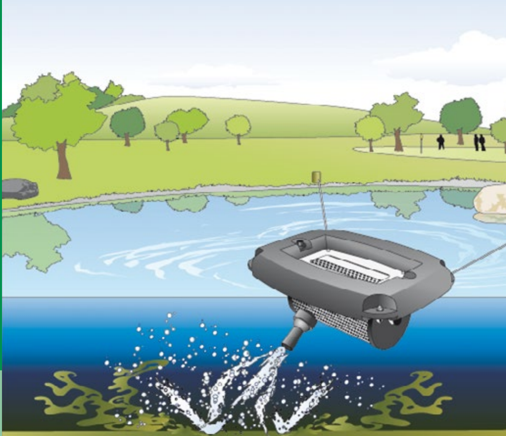
Rappresentazione schematica: ossigenatore per laghetti AquaAir 250 in uso - distribuisce l'ossigeno in maniera ottimale nel laghetto
