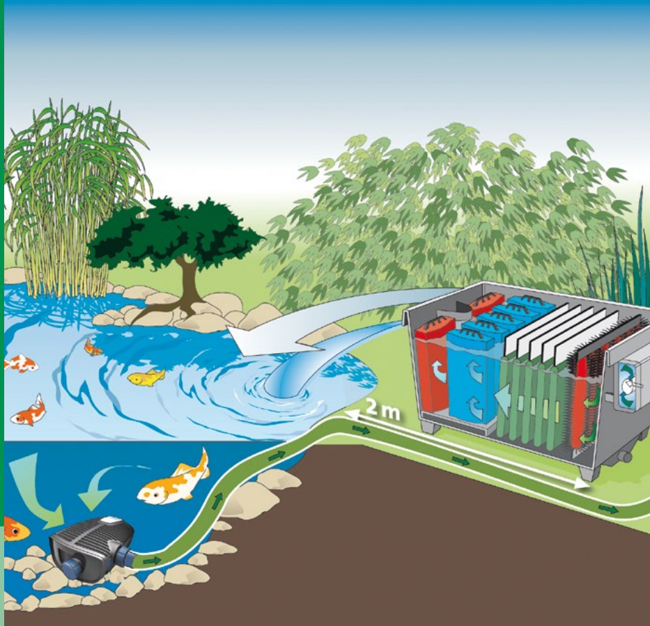
Rappresentazione schematica: BioTec 30 in funzione con una pompa per filtri e ruscelli e un Bitron C
