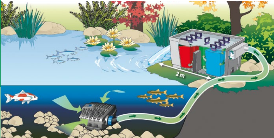
Rappresentazione schematica: BioSmart 36000 in combinazione con la pompa per filtri e ruscelli AquaMax Eco Classic
