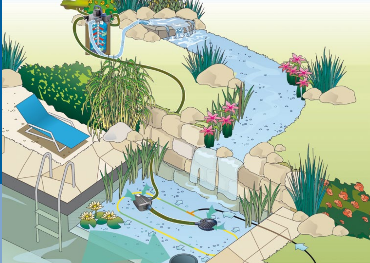
Rappresentazione schematica: pompa per filtri e ruscelli AquaMax Eco Premium 12 V utilizzata in un laghetto balneabile in combinazione con un filtro a pressione OASE FiltoClear
