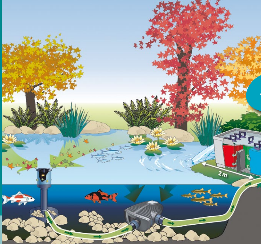
Rappresentazione schematica: AquaSkim in uso con una pompa per filtri e ruscelli AquaMax Eco Premium
