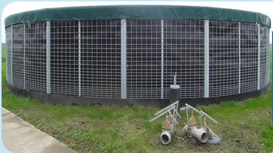
La vasca in rete è costruita con elementi di acciaio galvanizzato a caldo con altezza di 3 metri e larghezza di 2,5 metri. I volumi possibili vanno da 192 a 1.695 metri cubi. Il silo a griglia è certificato Komo-Kiwa per liquami zootecnici.
